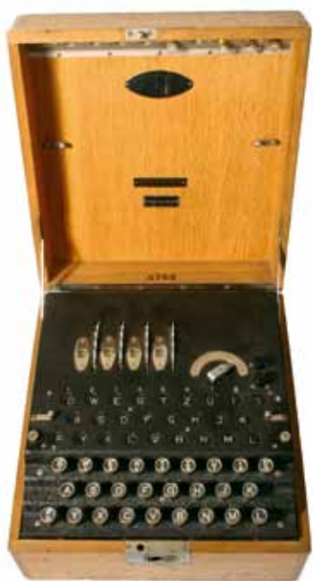
Enigma – niemiecka przenośna, elektromechaniczna maszyna szyfrująca działająca na zasadzie obracających się wirników, złamana przez Polaków FOT. MUZEUM WOJSKA POLSKIEGO
